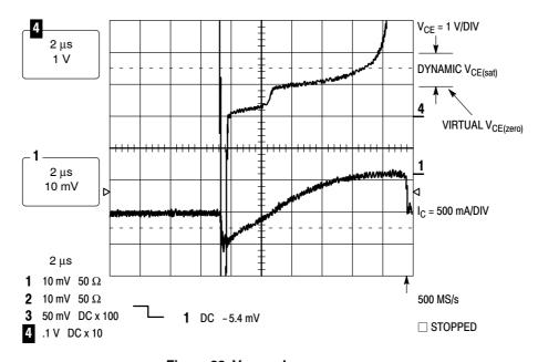
Figure 28. V<sub>CE(sat)</sub> Losses
